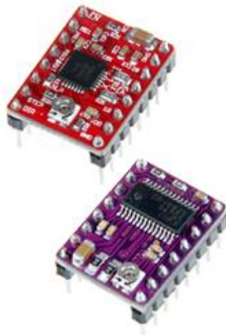
Ilustración 31 Driver A4988 y DRV8825
