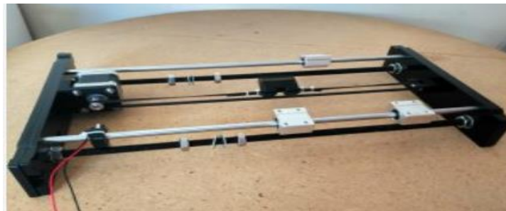
Ilustración 5 Montaje de un sistema de transmisión de movimiento por correas para el eje Y
