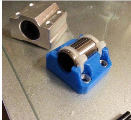
Ilustración 23 Rodamiento lineal, en conjunto de la varilla.
