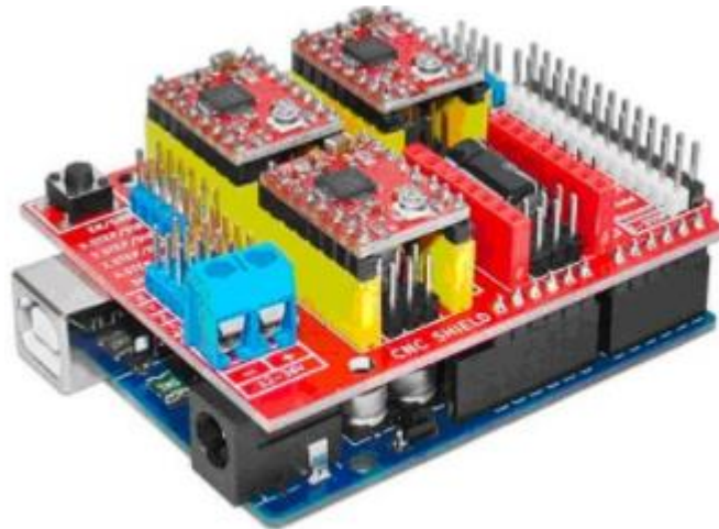
Ilustración 30 Placa shield CNC, acoplada en el arduino uno.
